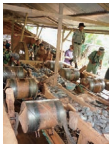
水銀と金鉱石を混合して水銀アマルガムを生成するミル
